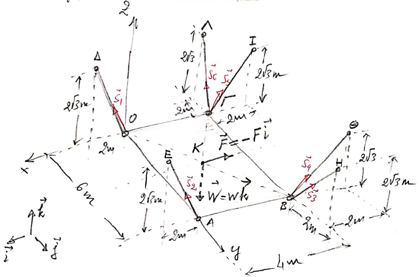
Divisão Operam 4 pilões de aço  $W=20kN$ , com separação entre os 6 m entre eixos, sendo paralelos ao solo. A ação sísmica sobre o topo é  $F=10 kN$ .
