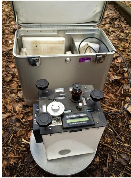
Βαρυτόμετρο LaCoste – Romberg, στερεωμένο στη βάση του. (Πηγή: DeepEarthScience)
