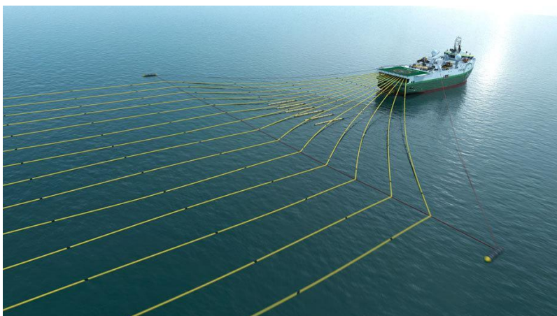
Σεισμογραφικό πλοίο με ενδεικτικά τα αεροβόλα και τις σειρές με τα υδρόφωνα. (Πηγή: SATEL)
