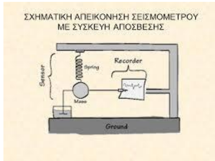
Εικόνα 23. (Σχηματική απεικόνιση σεισμομέτρου με συσκευή απόσβεσης)
