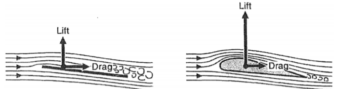
Εικόνα 12: Μεγαλύτερη κυρτότητα – μεγαλύτερη άντωση
