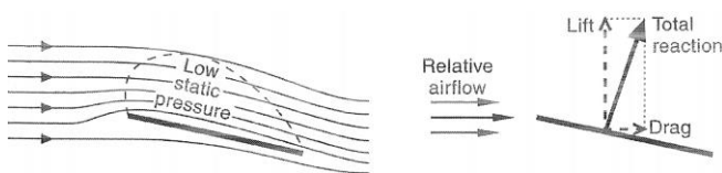
Εικόνα 10: Το κατώρευμα πίσω από την επίπεδη πλάκα
