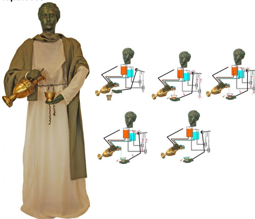
Εικόνα 2: Ο εσωτερικός μηχανισμός του Ρομπότ-Υπηρέτη (πηγή: εδώ )
