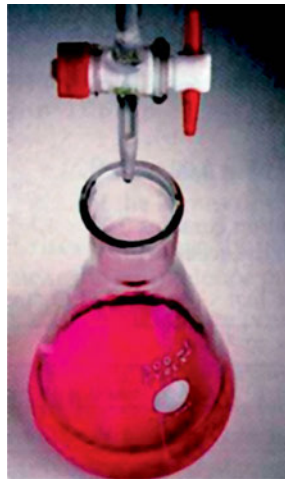
ΣΧΗΜΑ 5.18 Κατά την ογκομέτρηση της ασθενούς βάσης \text{NH}_3 με πρότυπο διάλυμα \text{HCl} η αλλαγή του χρώματος του ερυθρού του μεθυλίου από κίτρινο σε κόκκινο πιστοποιεί το τέλος της ογκομέτρησης (ισοδύναμο σημείο).
