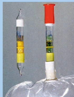
Αλκοτέστ μπορεί να γίνει με βάση την αλλαγή χρώματος που προκαλεί η οξείδωση της αλκοόλης σε K 2 Cr 2 O 7 (από πορτοκαλί σε πράσινο).
