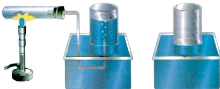
ΣΧΗΜΑ 8.12 Συλλογή αερίου πάνω από νερό και μέτρηση του όγκου του. Η διάταξη δείχνει τη συλλογή αερίου κατά την θερμική διάσπαση ενός στερεού π.χ. \text{KClO}_3 .
