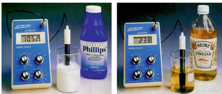
ΣΧΗΜΑ 5.9 Προσδιορισμός της τιμής pH με πεχάμετρο σε: α. γάλα της μαγνησίας - διάλυμα \text{Mg}(\text{OH})_2 β. ξύδι - διάλυμα \text{CH}_3\text{COOH} .
