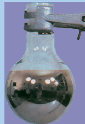
Οι αλδεΐδες αντιδρούν με το αντιδραστήριο Tollens και σχηματίζουν κάτοπτρο. Η αντίδραση αυτή χρησιμεύει για τη διάκριση μεταξύ αλδεϋδών και κετονών.
