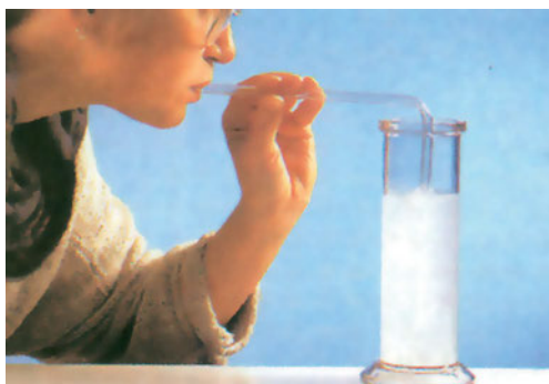
ΣΧΗΜΑ 7.24 Το CO_2 θολώνει το διάλυμα ασβεστόνερου.
