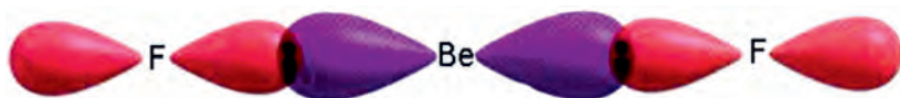
ΣΧΗΜΑ 7.6 Σχηματισμός δύο \sigma δεσμών με επικάλυψη δύο sp υβριδικών τροχιακών του Be με ισάριθμα p τροχιακά του F για τη δημιουργία του μορίου \text{BeF}_2 .
