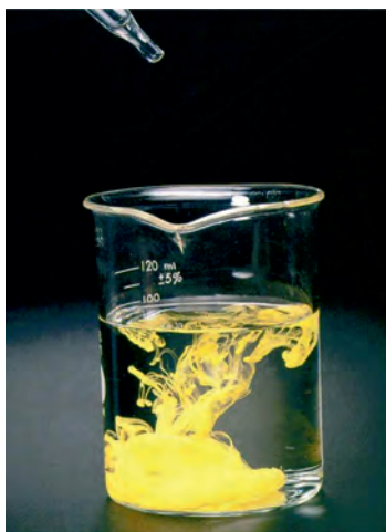
ΣΧΗΜΑ 5.22 Σχηματισμός ιζήματος PbI_2 κατά την ανάμιξη διαλύματος Pb(NO_3)_2 με διάλυμα KI .
