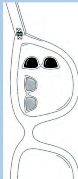
Αν τα επίπεδα πόλωσης του φωτός είναι κάθετα μεταξύ τους, τότε το φως δεν περνάει σχεδόν καθόλου (όπως συμβαίνει στα γυαλιά ηλίου).
