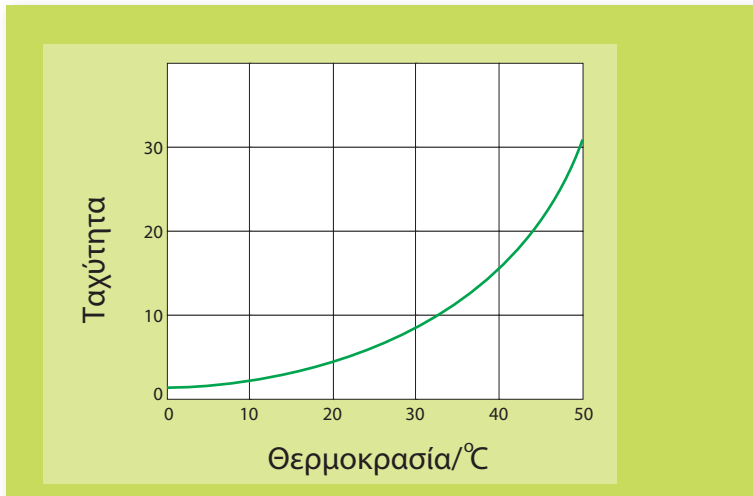
ΣΧΗΜΑ 3.4 Η ταχύτητα μιας αντίδρασης μεταβάλλεται εκθετικά με τη θερμοκρασία. Αύξηση της θερμοκρασίας κατά 10 °C προκαλεί αύξηση της ταχύτητας, ανάλογα με την αντίδραση, από 1,5 έως 4 φορές.
