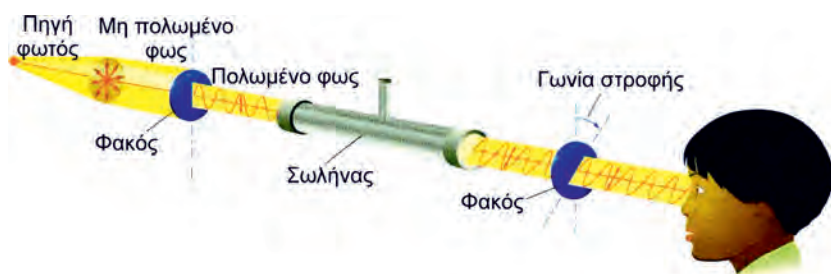
ΣΧΗΜΑ 7.21 Σχηματική παρουσίαση ενός πολωσίμετρου. Η οπτικά ενεργή ουσία στρέφει το επίπεδο του πολωμένου φωτός.
