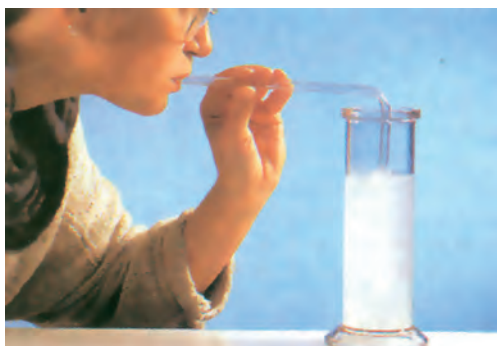
ΣΧΗΜΑ 7.24 Το CO_2 θολώνει το διάλυμα ασβεστόνερου.
