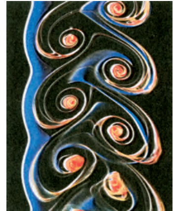
Ρίχνοντας χρώματα μέσα σε ένα ρευστό που κάνει τυρβώδη ροή έχουμε μια εικόνα των δινών που σχηματίζει.
