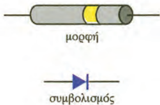
Μορφή και συμβολισμός δίοδου. Εικόνα 2.11-51.
