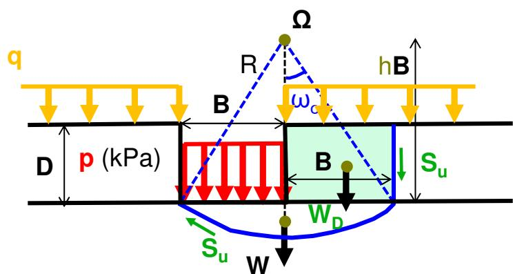
Για να αστοχήσει... ολίσθηση μέχρι την επιφάνεια του εδάφους επιπλέον αντίσταση  $S_u D$  σταθεροποιητικό βάρος  $W_D = \gamma BD$
