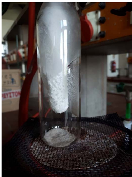
Σχήμα 6. Στερεοποιημένο \text{NH}_4\text{Cl} στα τοιχώματα του εσωτερικού σωλήνα
