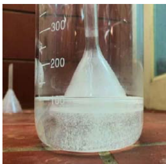
Εικόνα 1. Σχηματισμός κρυστάλλων NaCl και καταβύθιση.
