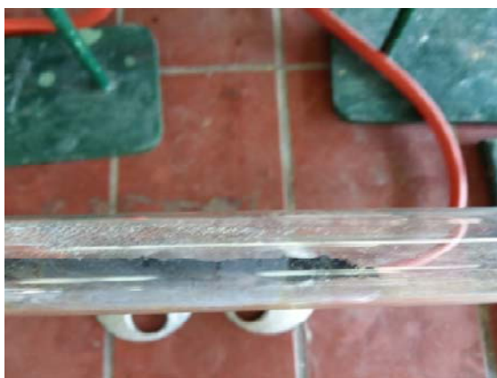
Σχήμα 1. Τοποθέτηση \text{CuO} στο σωλήνα
