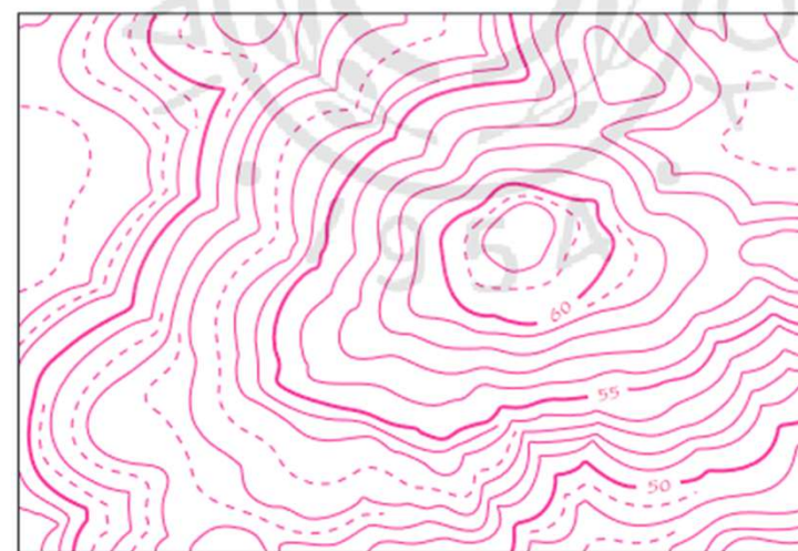
Σχ. 6.11. Κύριες, δευτερεύουσες και βοηθητικές χωροσταθμικές καμπύλες.
