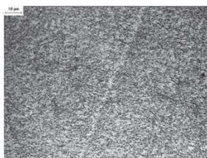
Μαρτενσίτης εξ' επαναφοράς (κλίμακα 10 μm)
