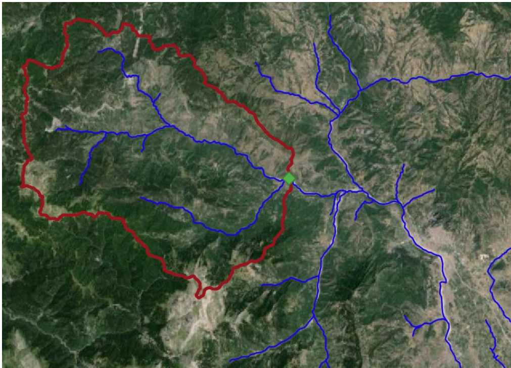
Εικόνα 1: Περιοχή ενδιαφέροντος, στην οποία απεικονίζονται το υδρογραφικό δίκτυο, η θέση υδροληψίας και τα όρια της ανάντη λεκάνη απορροής.
