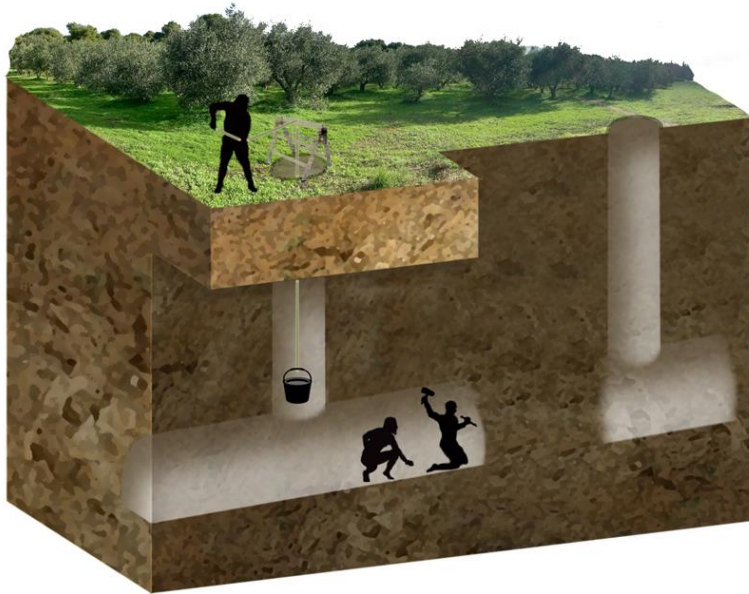
Κατασκευή της σήραγγας του Αδριάνειου υδραγωγείου
