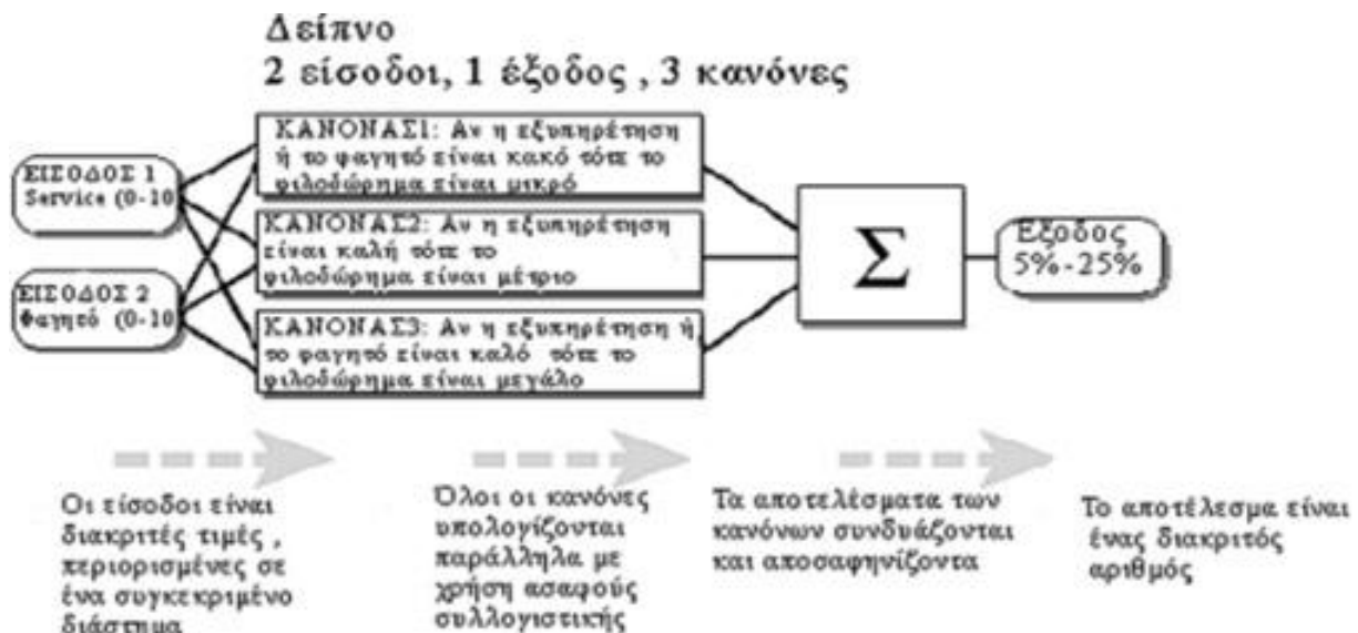
Σχήμα 21: Βασική δομή του συστήματος Mamdani στην περίπτωση του προβλήματος του φιλοδωρήματος
