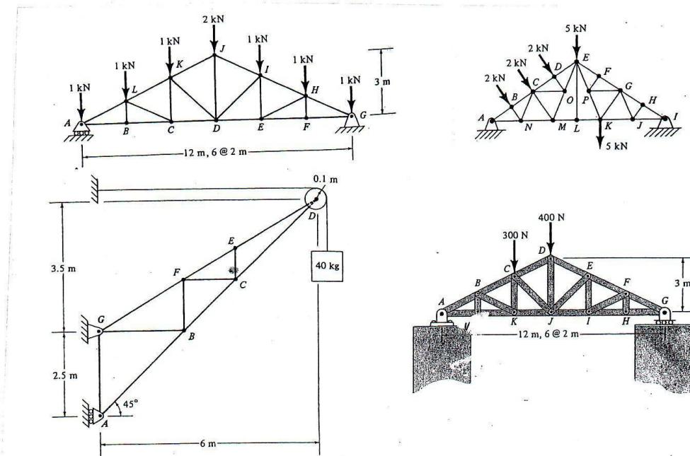
3. Στο δικτύωμα του σχήματος δίνεται ότι η μέγιστη δύναμη που μπορεί να αναπτυχθεί σε οποιαδήποτε εφελκυόμενη ράβδο είναι  $100\text{KN}$ , ενώ η μέγιστη θλιπτική δύναμη είναι  $60\text{KN}$  για οποιαδήποτε θλιβόμενη ράβδο. Να βρεθεί η μέγιστη ανεκτή τιμή του  $P$ , για την εικονιζόμενη φόρτιση του δικτυώματος στο κόμβο  $\Gamma$ .
