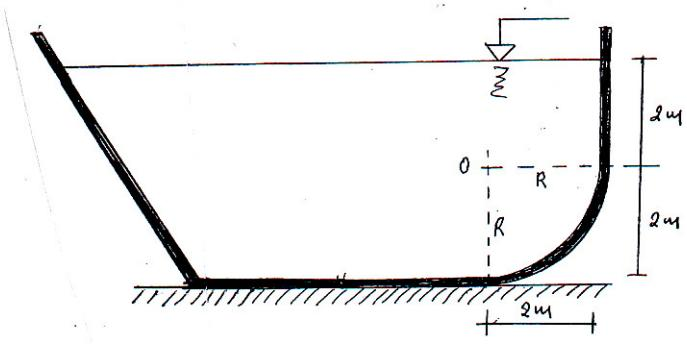
8. Υπολογίστε το μέτρο της συνισταμένης υδροστατικής δύναμης που ενεργεί στην επιφάνεια του τοίχου που βρίσκεται μέσα στο νερό και ο οποίος έχει σχήμα παραβολής. Ο τοίχος έχει 5m μήκος. Η πυκνότητα του νερού είναι  $\rho_v = 1020 \text{ kg/m}^3$ .
