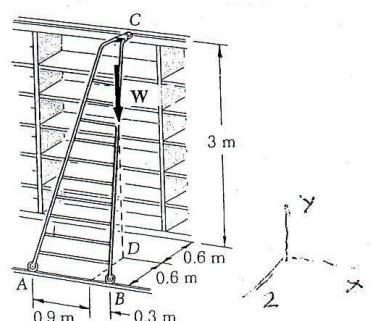
6. Για το στύλο του σχήματος να υπολογισθούν οι εφελκυστικές δυνάμεις στα καλώδια BC και BD καθώς και η αντίδραση στο A (σφαιρική άρθρωση).
