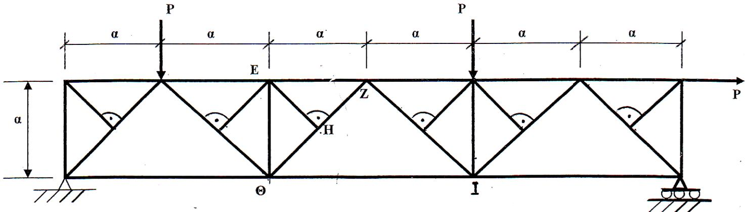
5. Ο φορέας του Σχ.. στηρίζεται με αρθρώσεις στους κόμβους A και H. Άπο τους κόμβους L και O αναρτάται με τη βοήθεια κατακορύφων συρματοσχοίνων λεπτή επίτεδη πλάκα πάχους 3.6 mm από υλικό ειδικού βάρους  $1 \text{ MN/m}^3$ . Να υπολογισθεί η γωνία θ έτσι ώστε η ράβδος (JH) να είναι αφόρτιστη (Περιόρισμός:  $0 < \theta < 45^\circ$ ). Για τη γωνία αυτή να υπολογιστούν οι δυνάμεις στις ράβδους (LI) και (JM).
