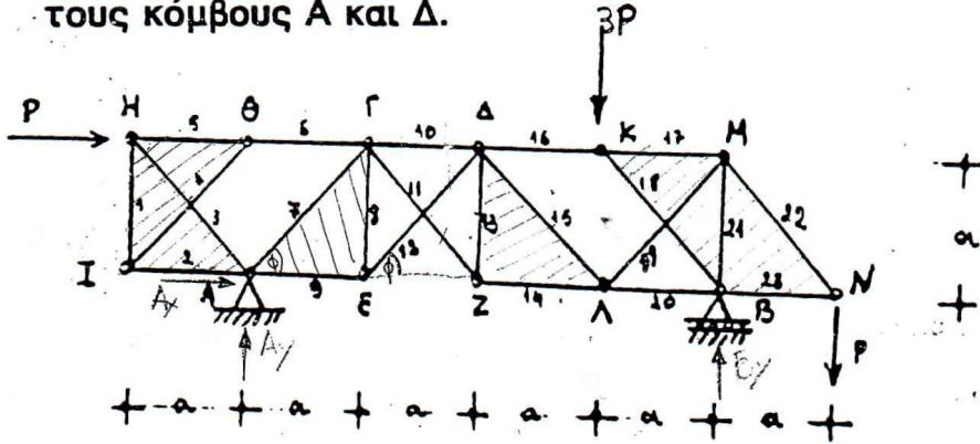
2. Δίδεται το δικτύωμα του σχήματος. Να εξεταστεί εάν είναι ισοστατικό και στερεό και να υπολογισθούν οι τάσεις των ράβδων 1,2,3,4,5,6. Διευκρινίζεται ότι τα σημεία M,N δεν αποτελούν κόμβους.
