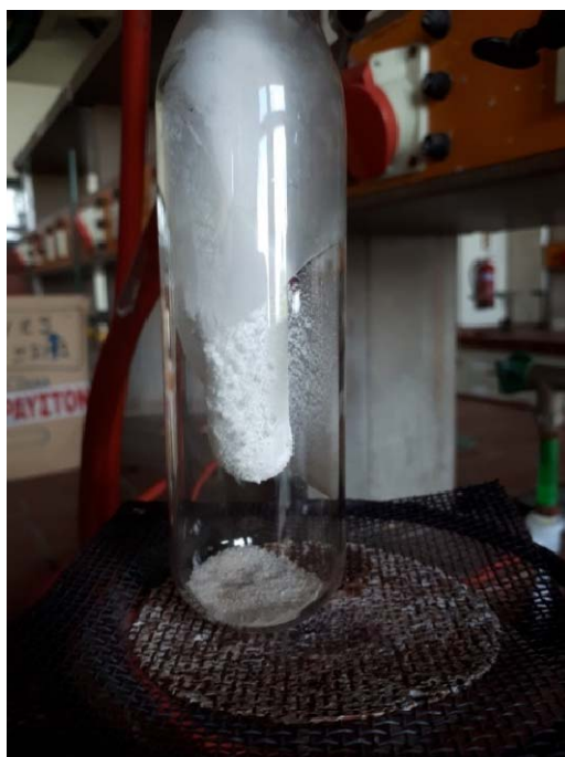
Σχήμα 6. Στερεοποιημένο \text{NH}_4\text{Cl} στα τοιχώματα του εσωτερικού σωλήνα
