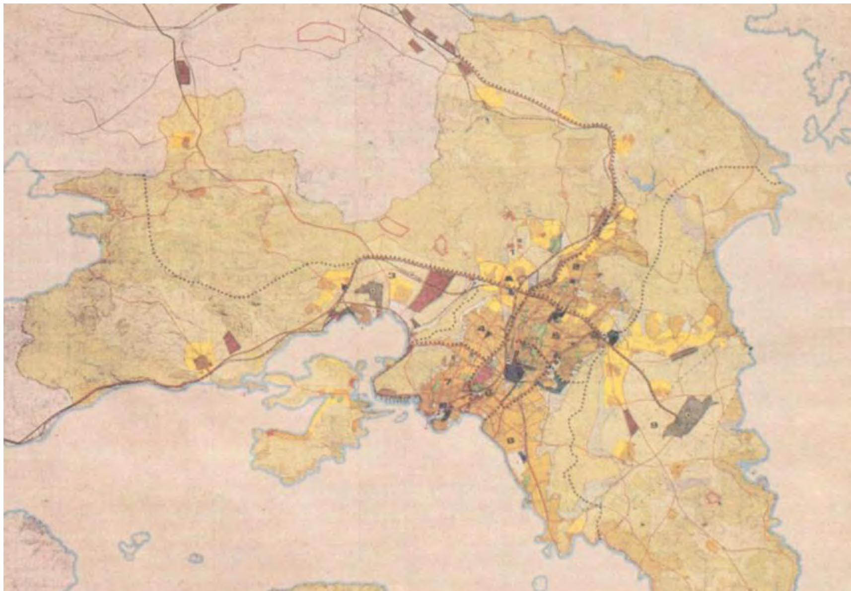
Το Σχέδιο Πλαίσιο: «Πρωτεύουσα 2.000» σε μια προτελική φάση της επεξεργασίας του το 1979 από την Γεν. Διεύθυνση Οικισμού του τότε Υπουργείου Δημοσίων Έργων και αμέσως μετά ΥΧΟΠ. Διακρίνονται τα όρια της οικιστικής περιοχής, οι ζώνες μελέτης της οικιστικής ανάπτυξης, το βασικό οδικό δίκτυο, ο διαχωρισμός της Αττικής σε 9 διαμερίσματα, οι βιομηχανικές ενότητες, το αεροδρόμιο στα Σπάτα κλπ. (Πηγή: Αρχείο ΥΧΟΠ, βλ. και ΦΕΚ 341, τ.Β. 2-4-1980, συνημμένος χάρτης).
