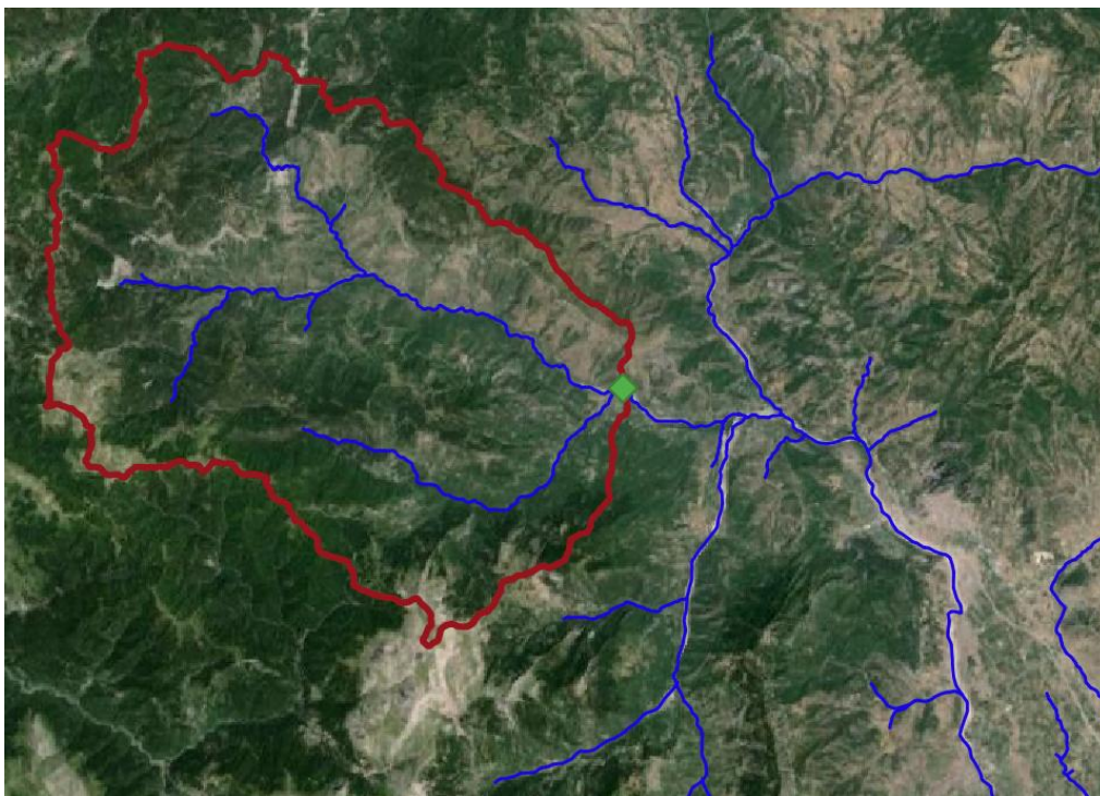
Εικόνα 1: Περιοχή ενδιαφέροντος, στην οποία απεικονίζονται το υδρογραφικό δίκτυο, η θέση υδροληψίας και τα όρια της ανάντη λεκάνη απορροής.
