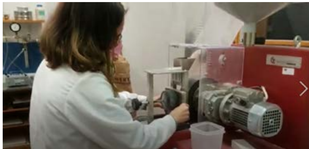
Video 4: Test tube placement and abrasion process. (Source: Centro Tecnológico del Mármol, Piedra y Materiales)
