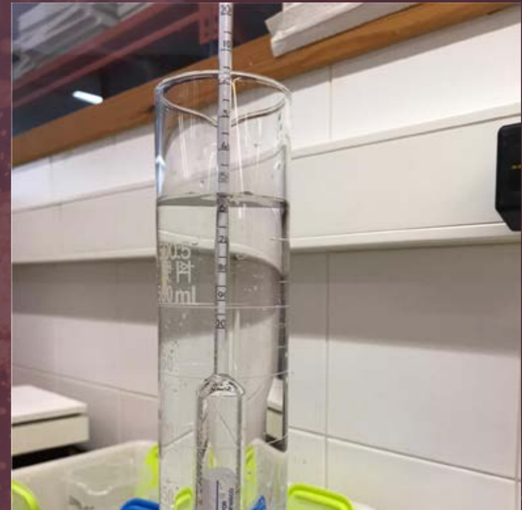
Figure 28: Density check. (Source: Centro Tecnológico del Mármol, Piedra y Materiales)
