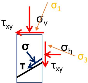
Εάν στο εδαφικό στοιχείο εκτός από την κατακόρυφη  $\sigma_v = 200\text{kPa}$  και οριζόντια τάση  $\sigma_h = 100\text{kPa}$  ασκείται και μία διατμητική τάση  $\tau_{xy} = 50\text{kPa}$  ζητείται: α) να σχεδιαστεί ο κύκλος Mohr, β) να υπολογιστούν οι τάσεις στο επίπεδο με  $\theta = 30^\circ$  ως προς την οριζόντιο και γ) να υπολογιστούν οι κύριες τάσεις
