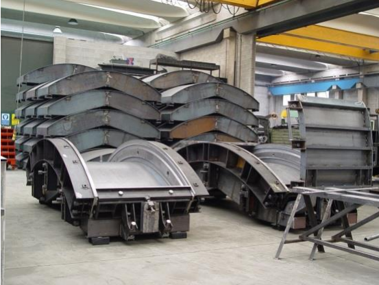
Σχήμα 10-2. Αριστερά: Μεταλλότυπος κενός. Δεξιά: Τοποθετημένος οπλισμός
