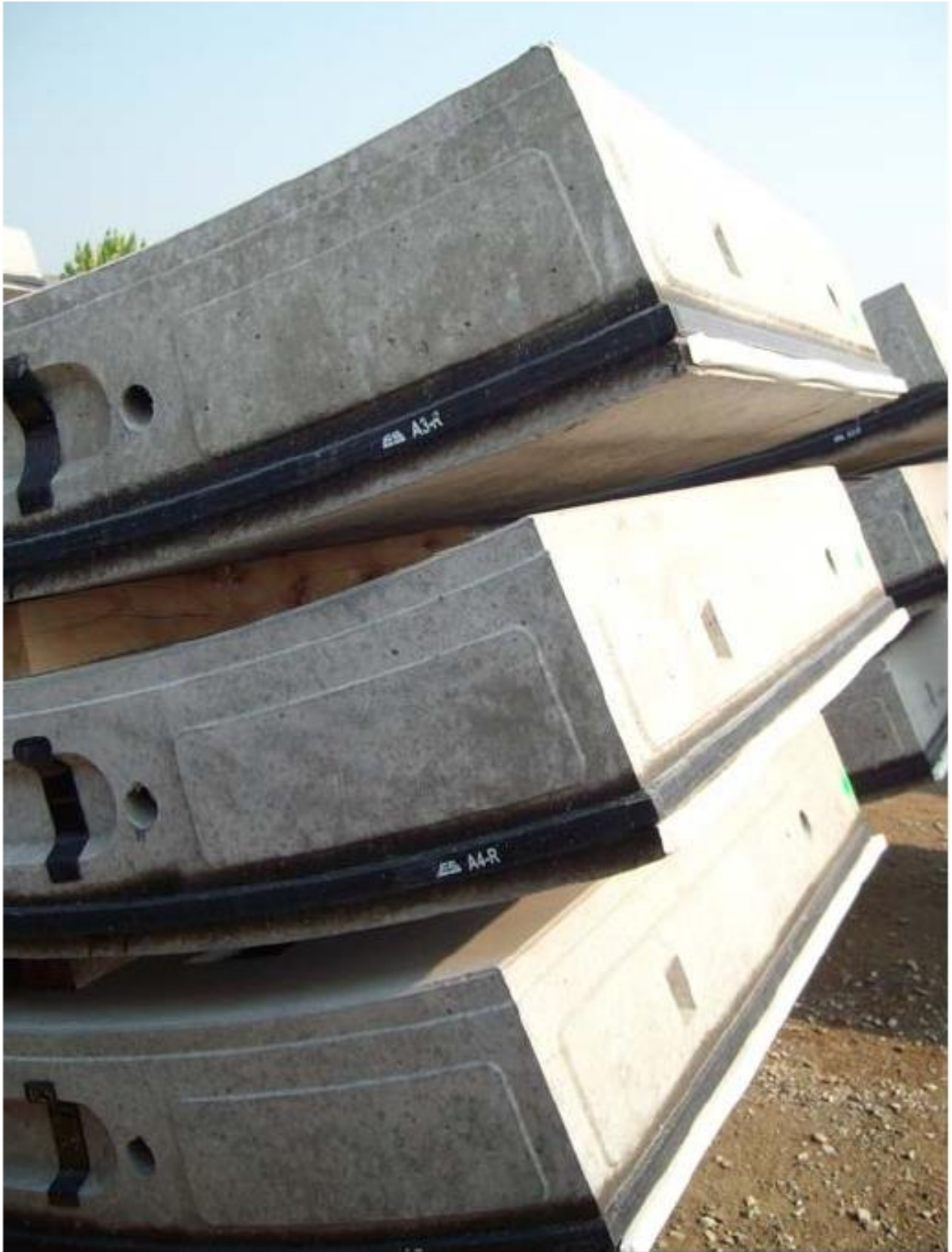
Σχήμα 10-18. Συνεχές παρέμβυσμα περιφερειακά του στοιχείου
