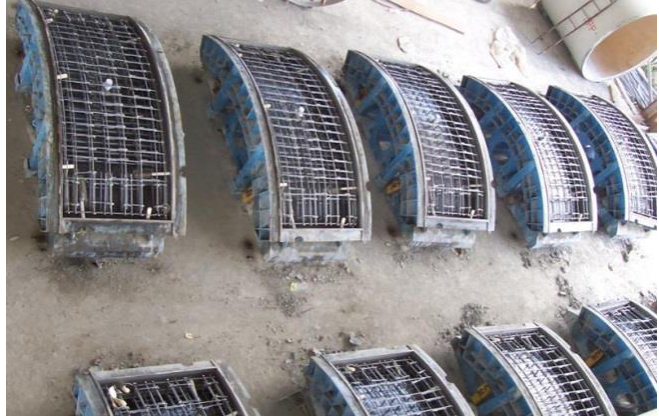
Σχήμα 10-2. Αριστερά: Μεταλλότυπος κενός. Δεξιά: Τοποθετημένος οπλισμός
