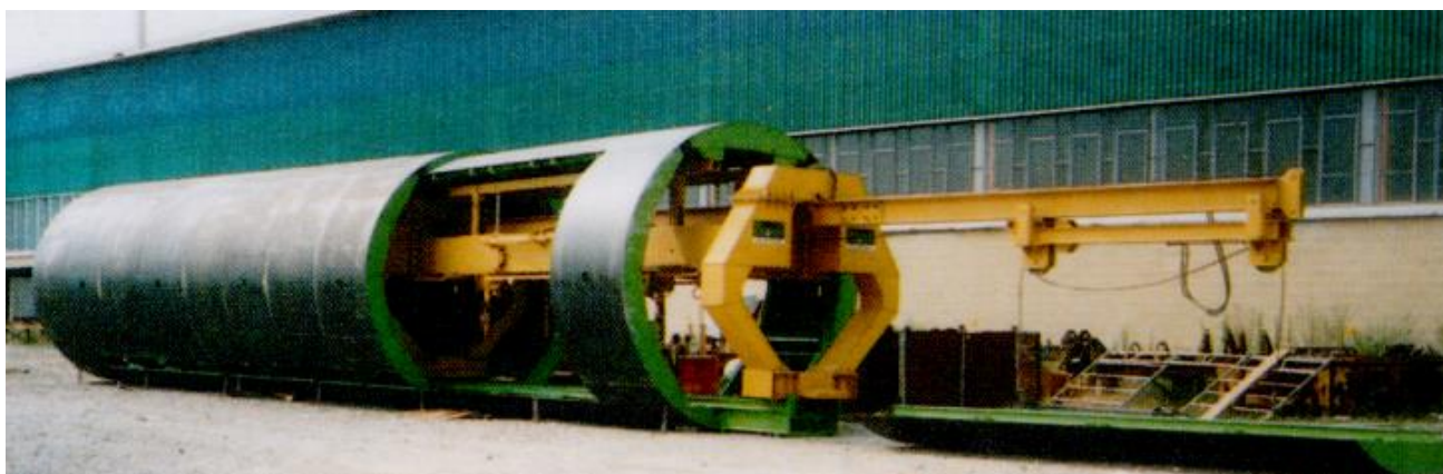
Σχήμα 8-9. Μεταλλότυπο ολόκληρης της διατομής
