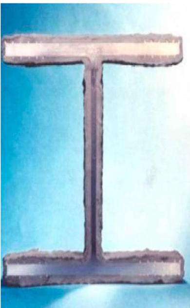
Εικόνα 12.15: Εφαρμογή διογκωμένων επιστρωμάτων στον οπλισμό (Davidson et al., 2013).
