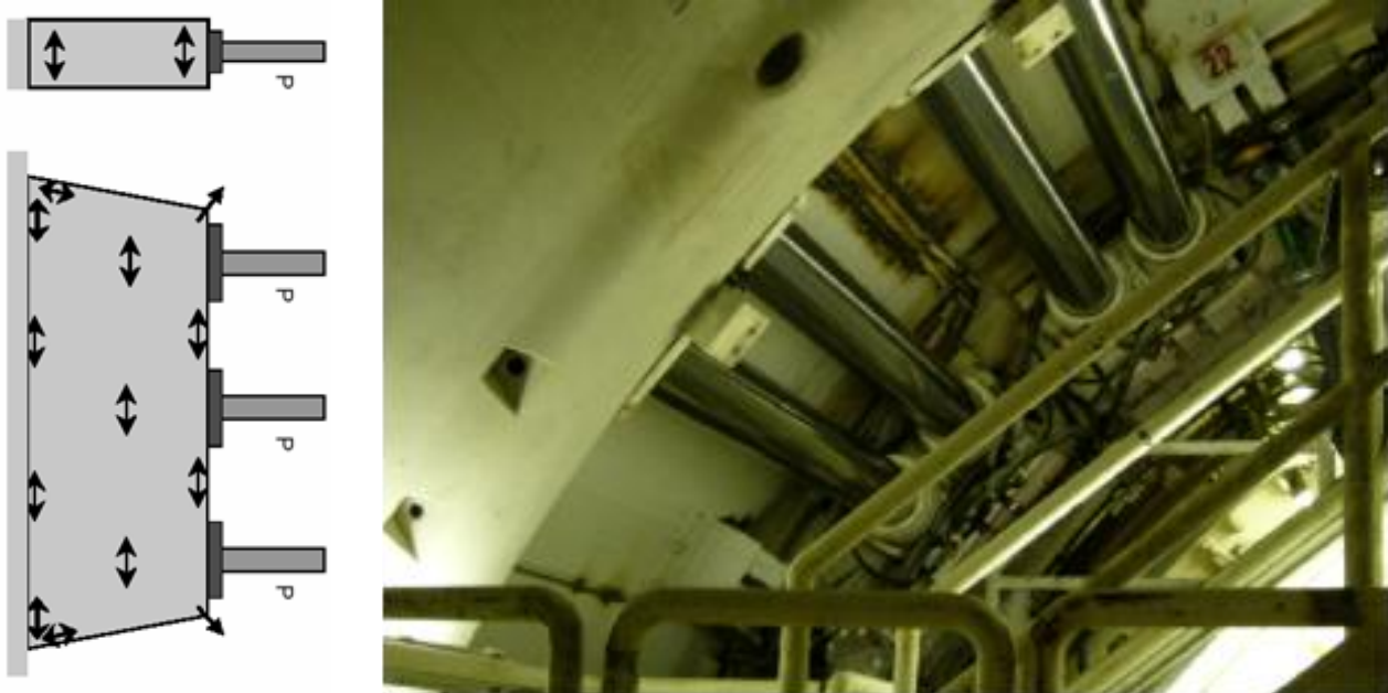
Σχήμα 10-23. Κατανομή της δύναμης εφελκυστικής διάρρηξης μέσα στο τόξο
