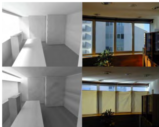
Σχήμα 6-5: Εξισορρόπηση λαμπρότητας με περιορισμό του φυσικού φωτισμού που εισάγεται στο χώρο μέσα από σκιάστρα ή περισίδες.
