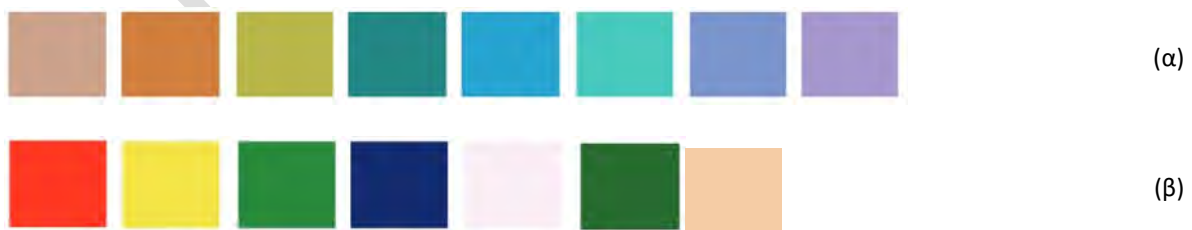
Σχήμα 3-14: Δείγματα χρωμάτων για τις δοκιμές των φασμάτων φωτεινών πηγών και του καθορισμού του δείκτη R_a ή CRI όπως έχουν καθοριστεί από τη Διεθνή Επιτροπή Φωτισμού (CIE) με τη χρήση 8 βασικών χρωμάτων (α) και 7 επιπρόσθετων χρωμάτων για το δείκτη R_{a15} (β).
