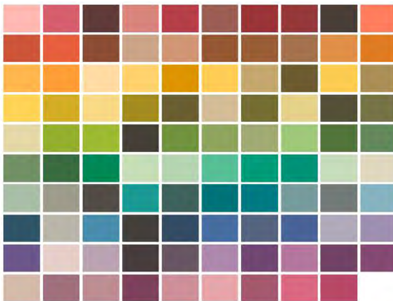
Σχήμα 3-15: Δείγματα χρωμάτων για τις δοκιμές των φασμάτων φωτεινών πηγών και του καθορισμού του δείκτη χρωματικής πιστότητας R_f (Fidelity Index).
