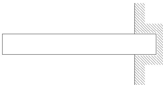
Σχήμα 11.4: Πρόβολος πακτωμένος σε οριζόντια εσοχή.
