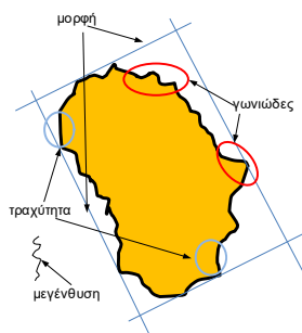
Σχ. 2.7: Γεωμετρικά χαρακτηριστικά κόκκου αδρανών
