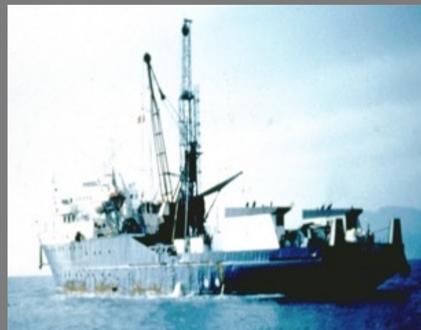
(γ) γεωτρύπανο σε πλωτό μέσο για γεωτρήσεις με βάθος θάλασσας μέχρι τα 40 m περίπου
