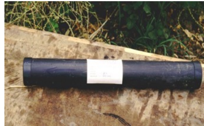
Τοποθέτηση των πλαστικών καλυμμάτων των άκρων και επισήμανση του δείγματος
