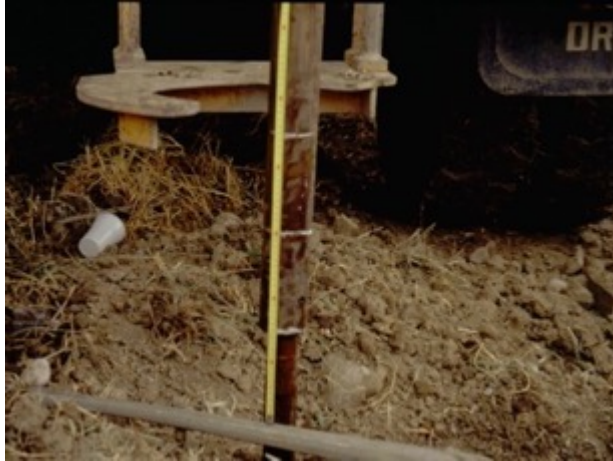
Επισήμανση πάνω στο στέλεχος των 45cm Διείσδυσης του δειγματολήπτη Terzaghi, ανά 15cm
