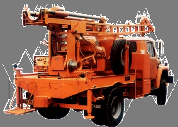
(α) γεωτρύπανο επί αυτοκινήτου
