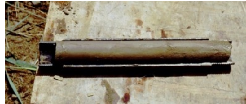
Απόληψη δείγματος από τον διαιρετό δειγματολήπτη και περιτύλιγμα με πανί
