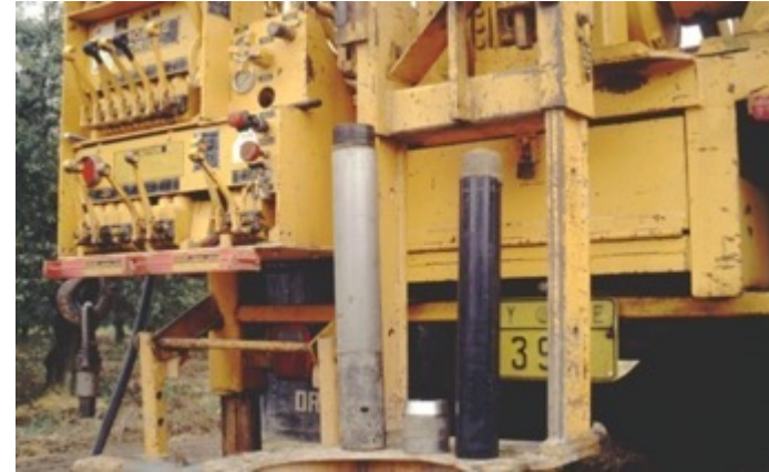
Λήψη δείγματος εντός του εσωτερικού Πλαστικού σωλήνα του δειγματολήπτη
