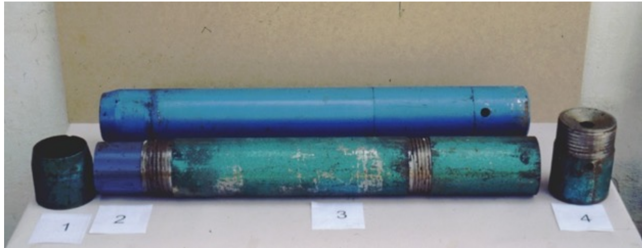
Δειγματολήπτης Shelby. 1: νύχι (κοπτικό πέλμα), 2: εσωτερικός πλαστικός σωλήνας, 3: εξωτερικός μεταλλικός σωλήνας, 4: κεφαλή
