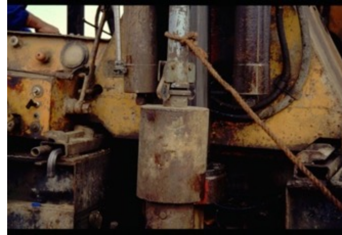
Ελεύθερη πτώση του αυτόματου βάρους των 63,5 kgr
