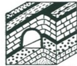
Άνομοιόμορφες τάσεις στην όροφή και στα τοιχώματα της σηράγγας. Μικρή έως μέτρια ροή νερού.
