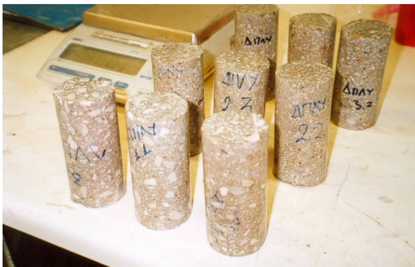
Σχήμα 4-16. Λήψη πυρήνων από τελέρα (Μιχαηλίδης & Γαρατζιώτης, 2009).
