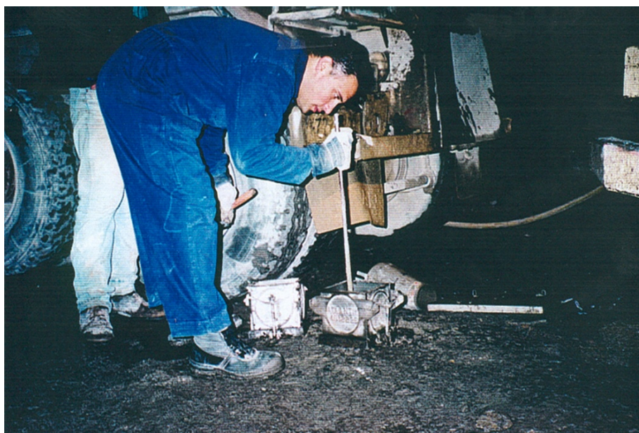
(α) Συμπύκνωση κυβικών δοκιμών σκυροδέματος ακμής 15cm Σχήμα 4-8. Πριν την εισαγωγή του επιταχυντή (Μιχαηλίδης & Γαρατζιώτης, 2009)
