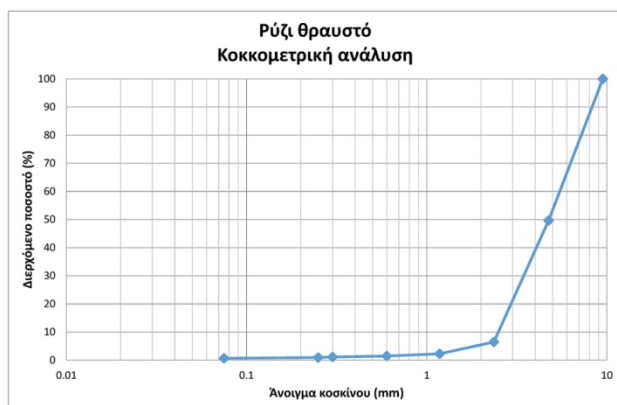
Σχήμα 4-20. Κοκκομετρική διαβάθμιση αδρανών
