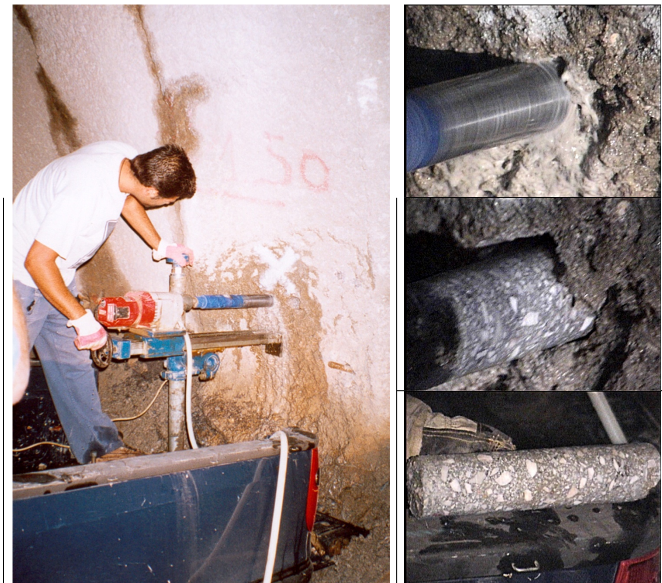
Σχήμα 4-17. Λήψη καρόντων από σήραγγα (Μιχαηλίδης & Γαρατζιώτης, 2009)
