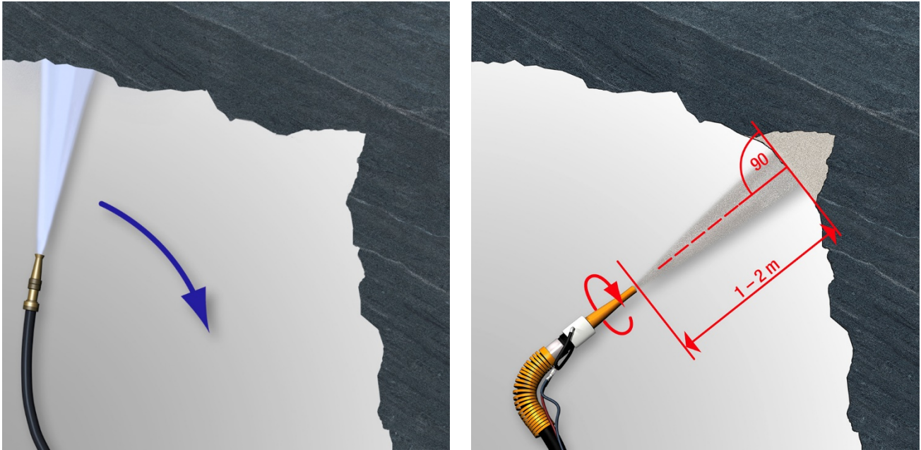
(α) Καθαρισμός από τη σκόνη του υποστρώματος με νερό.
