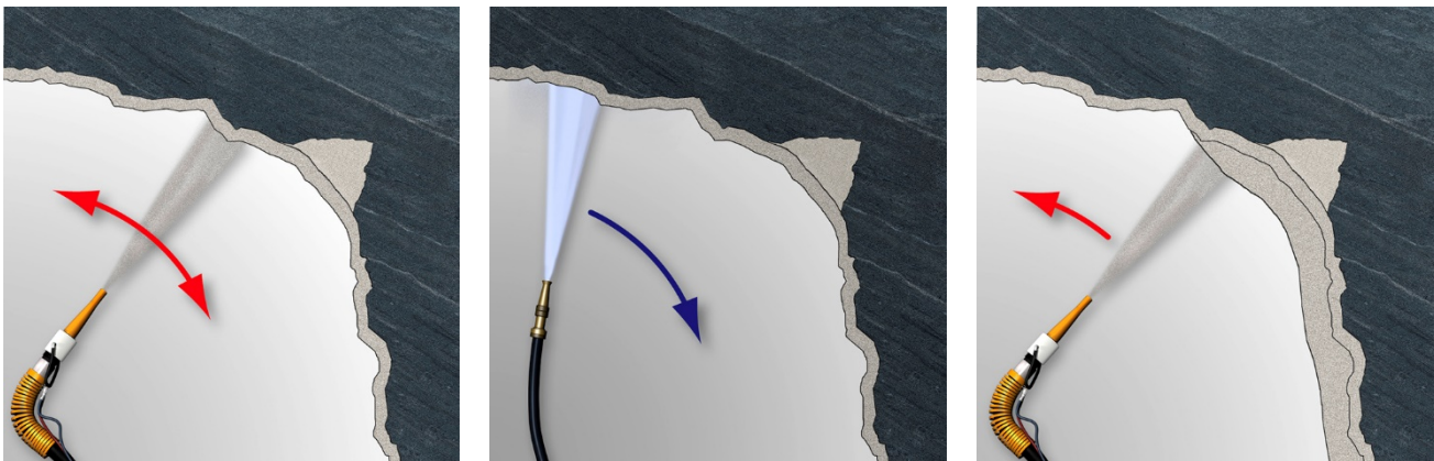
α. 1η στρώση σκυροδέματος για σταθεροποίηση μετά από το γέμισμα υπερεκσκαφών.
