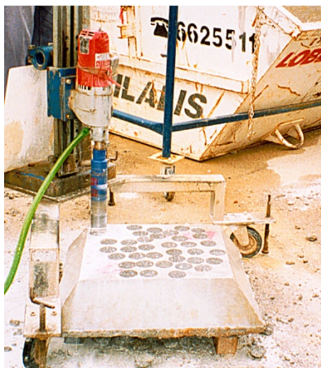
Σχήμα 4-16. Λήψη πυρήνων από τελέρα (Μιχαηλίδης & Γαρατζιώτης, 2009).
