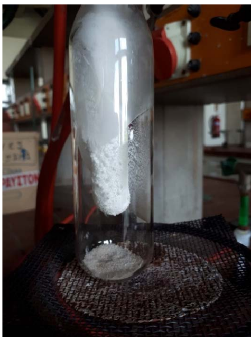
Σχήμα 6. Στερεοποιημένο \text{NH}_4\text{Cl} στα τοιχώματα του εσωτερικού σωλήνα
