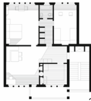
Fig. 5. Graphic method. Comparison between two plan models for four beds, published by Alexander Klein in “ Grundrissbildung und Raumgestaltung von Kleinwohnungen und neue Auswertungsmethoden ”, Berlin 1928
