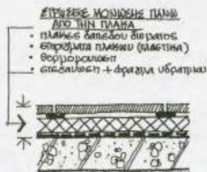
5.19.3. Αντεστραμμένη μόνωση σε βατό δώμα
