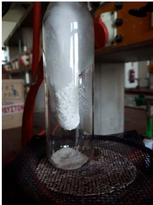
Σχήμα 6. Στερεοποιημένο \text{NH}_4\text{Cl} στα τοιχώματα του εσωτερικού σωλήνα
