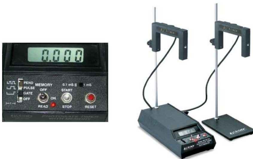
Σχήμα 7.4. Η κύρια φωτοπύλη με το χρονόμετρο και η βοηθητική φωτοπύλη.
