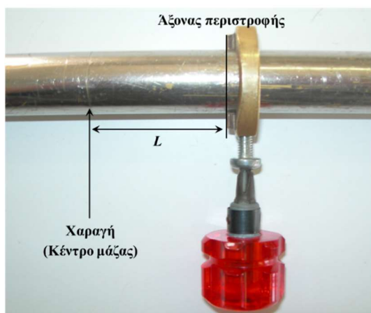
Σχήμα 2.4. Η τοποθέτηση της ράβδου στην ακίνητη βάση και η απόσταση L .
