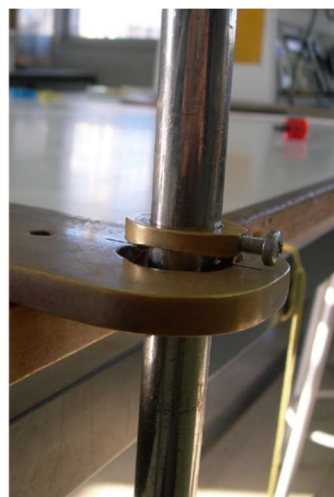
Σχήμα 2.4. Η τοποθέτηση της ράβδου στην ακίνητη βάση και η απόσταση L .
