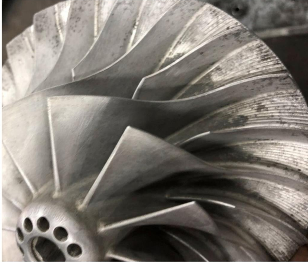
Βρόμισμα πτερυγίων συμπιεστή (π.χ. από ακαθαρσίες στον αέρα εισαγωγής ή από το λιπαντικό)
