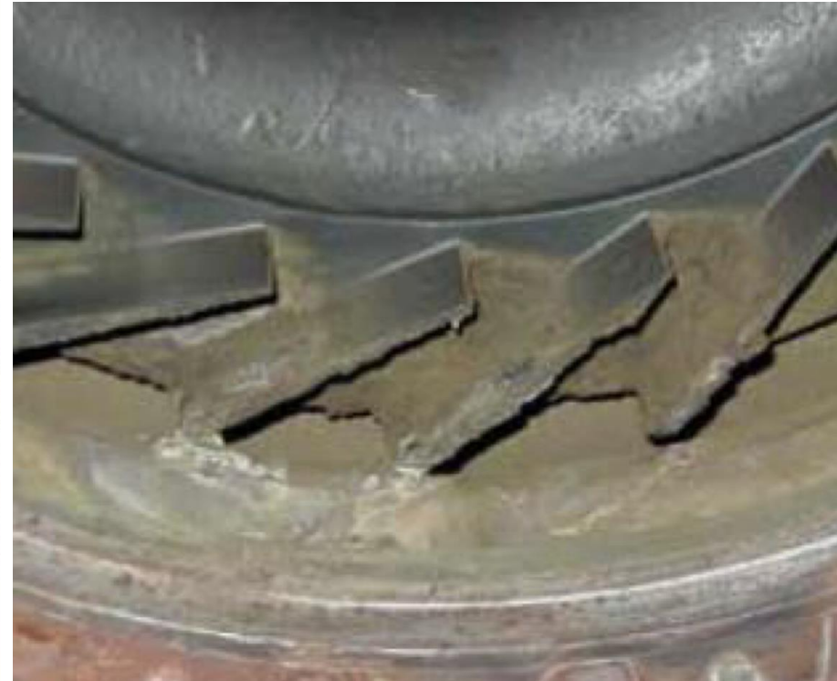
Βρόμισμα πτερυγίων στροβίλου (κυρίως από συστατικά καυσαερίου, κυρίως βαρύτερων κλασμάτων πετρελαίου )
