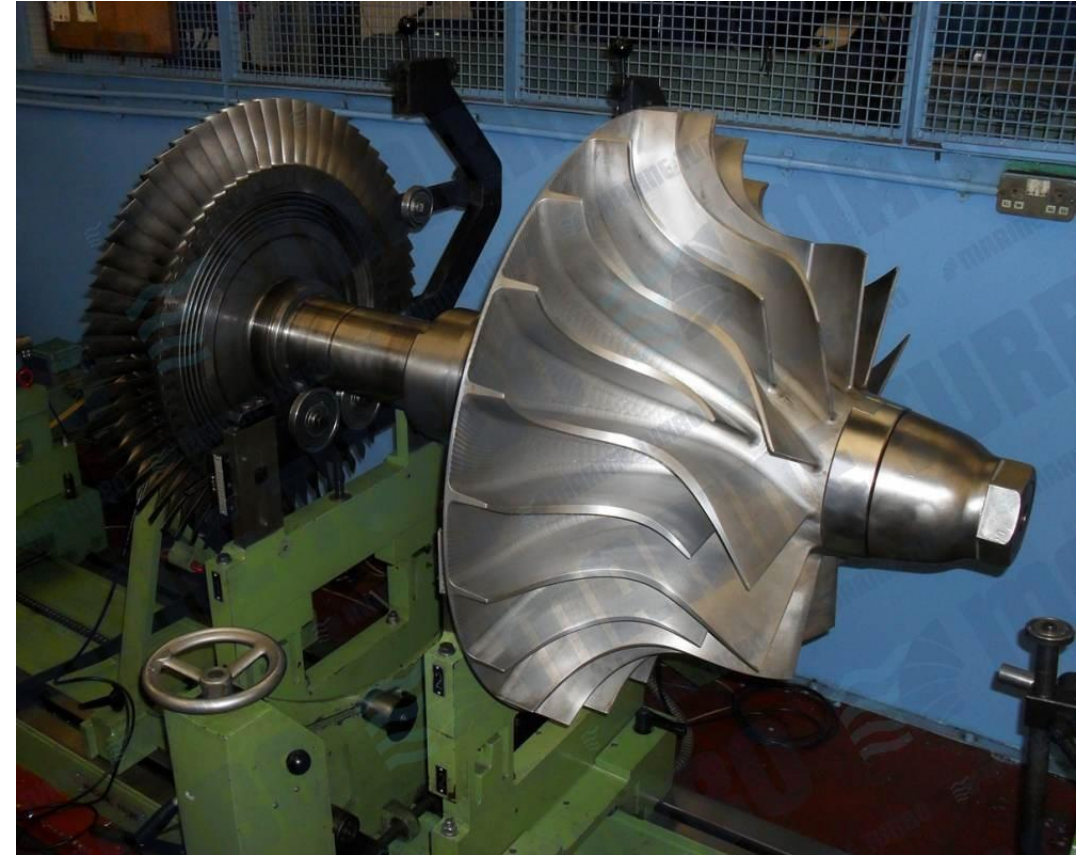
Ρότορας ακτινικού συμπιεστή και αξονικού στροβίλου
