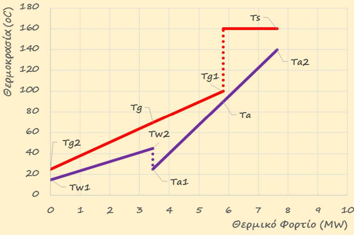
$$\text{Ορισμός } \Delta T_{\min} = T_{g1} - T_a$$
