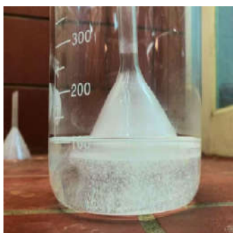
Εικόνα 1. Σχηματισμός κρυστάλλων NaCl και καταβύθιση.
