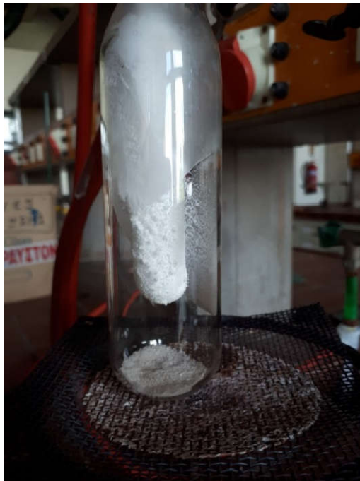
Σχήμα 6. Στερεοποιημένο \text{NH}_4\text{Cl} στα τοιχώματα του εσωτερικού σωλήνα
